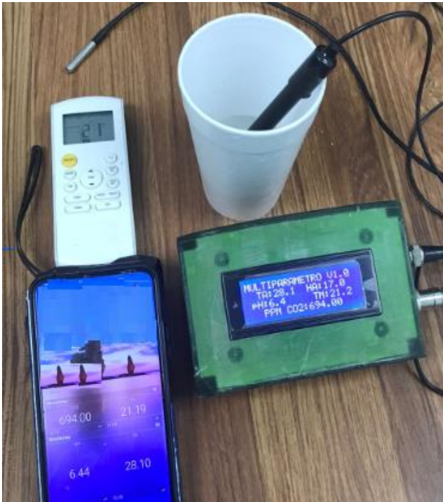
Fig. 6. Medición con el prototipo y visualización en tiempo real en diferentes lugares.
