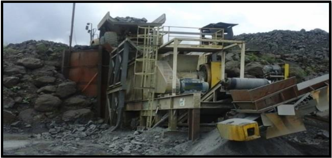
Fotografía N°1: Descarga de material del sitio de extracción a etapa primaria de trituración (mandíbula)
