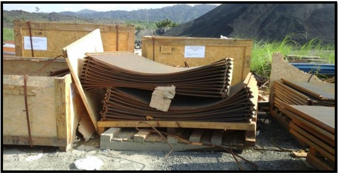
Fotografía N°6: Mallas para las cribas que permiten el tamizaje deseado
