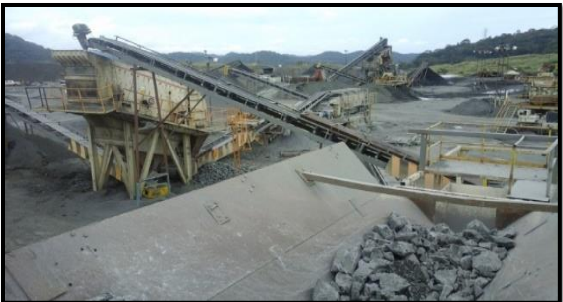
Fotografía N°2: Trituración (mandíbula) de material que es enviado al cribado por esteras
